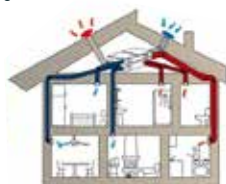
Ventilation permanente renouvelant l'air en continu (réglage individuel par appartement)
